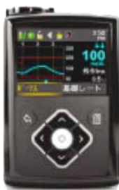
CSII。トランスミッタと通信しSAPとしても使用できる。
